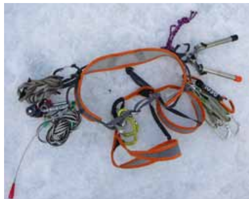
Przykładowy „zestaw indywidualny” na uprzęży: 2 x dyneema 120 cm, MiniTraxion, Tibloc, 1 x dyneema 240 cm, 2 x HMS, 2 x dyneema 60 cm, expres, 2 śruby lodowe, krótki rep (fi 6 mm). Uwaga: w zestawie także „jebadełko” do Abałakowa.
