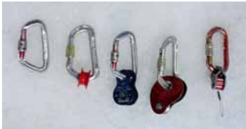
Zwykły karabinek zakręcany, karabinek z plastikową rolką, rolka metalowa, MiniTraxion (rolka z blokadą), RopeMAN.
