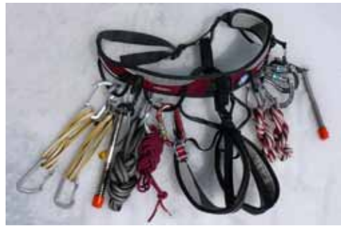
Przykładowy „zestaw indywidualny” na uprzęży: 2 x dyneema 60 cm, 2 śruby lodowe (16 i 19 cm), 1 x dyneema 240 cm, długi rep (fi 5,5 mm) 3m, RopeMAN, 2 x dyneema 120 cm, 2 x HMS.
