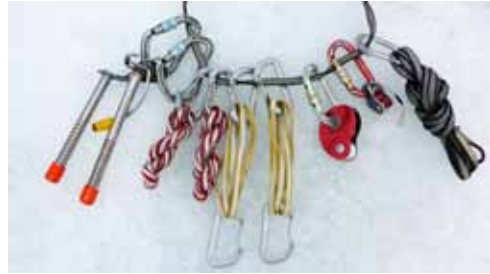
Przykładowy „standardowy zestaw indywidualny” na lodowcu: 2 x HMS, 2 x dyneema 120 cm, 1 x dyneema 240 cm, 2 x dyneema 60 cm, MiniTraxion, RopeMAN, 2 śruby lodowe, luźne i zakręcane karabinki.
